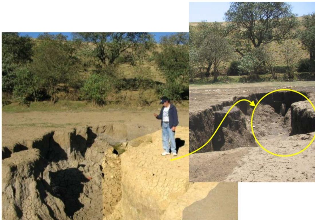
**Figura 2.5.** Cambio de geometría en fractura superficial de la zona de estudio por efecto de una lluvia intensa. En la fotografía de la derecha no aparece la parte donde está de pie el tesista. La diferencia temporal entre ambas fotografías es de siete días.
